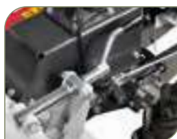
RÉGLAGE DE LA HAUTEUR DE COUPE par un levier.
