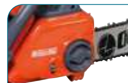
TENDEUR DE CHAÎNE LATÉRAL, réglable sans outil.
