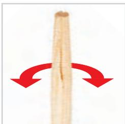
Puis de tourner l'outil et le manche pour obtenir un effet de compression entre eux. Ce qui permettra d'emmancher sans clous, ni vis et de travailler avec un outil solide et non fissuré.
