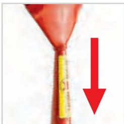
Pour fixer le manche à l'outil, il suffira d'utiliser le poids de l'outil en tapant ou laissant tomber au sol le bout du manche. Ce premier geste va permettre de chasser l'air via les rainures et encoches sur le manche et l'outil.
