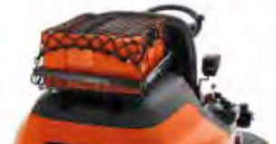
Porte-bagages à fixer sur rails et crochets existants sur le capot moteur.
